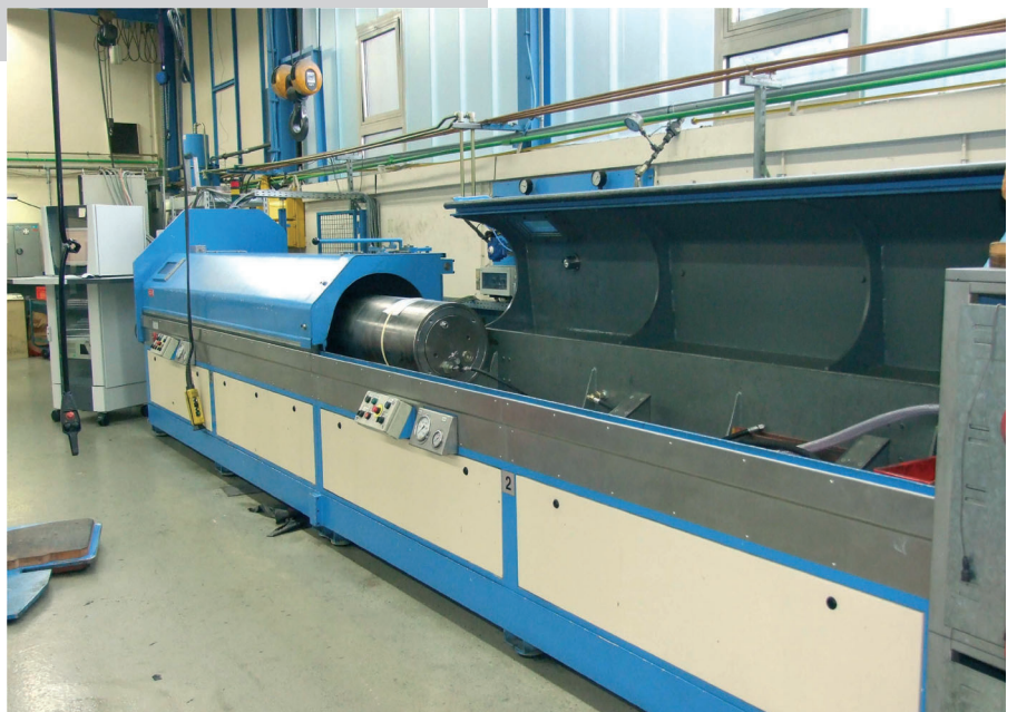
Bild 1. Automatische Prüfung von Hydraulikspeichern
